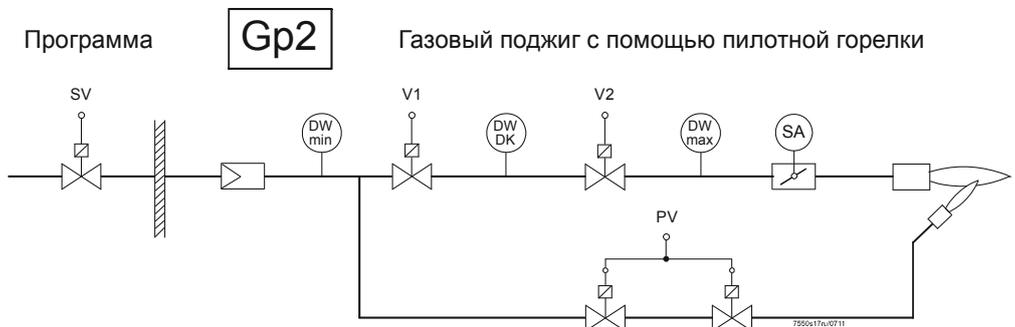
Программа управления топливным клапаном
