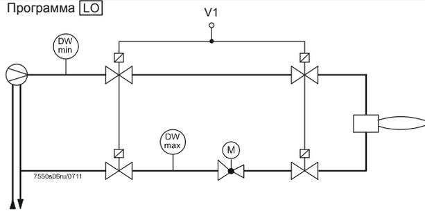
Модулирующая горелка (без устройства отсечки для регулирования сопла горелки)
