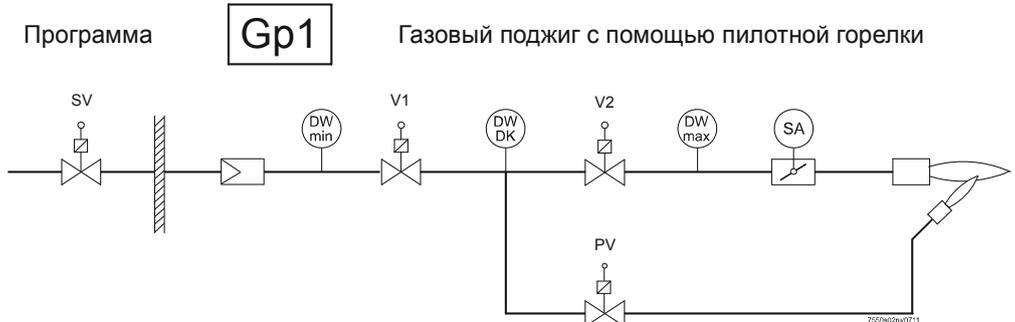
Розжиг при помощи дежурной горелки
