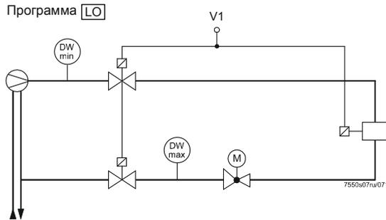
Модулированная горелка (с устройством отсечки для регулируемой головки)
